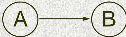
Две вершины **A** и **B** соединяются направленной дугой тогда и только тогда, когда вершина **B** может быть выполнена сразу после вершины **A**.
